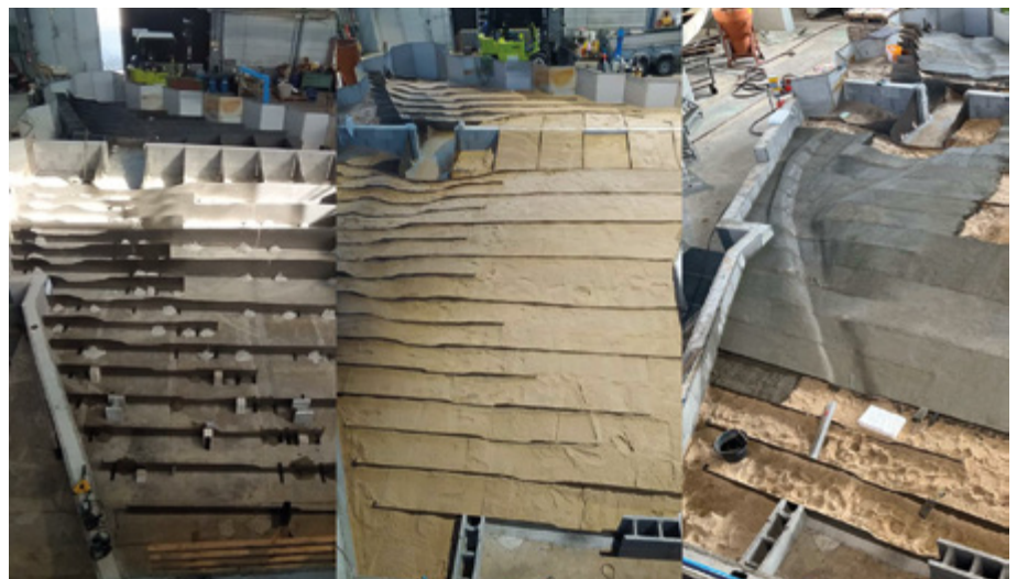
Herstellung der Topografie im wasserbaulichen Modell (Bildquelle: TU Darmstadt)
