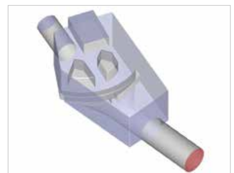
Computermodell Vereinigungsschachtbauwerk – Ausgangszustand (Quelle FlowConcept GmbH, Hannover)
